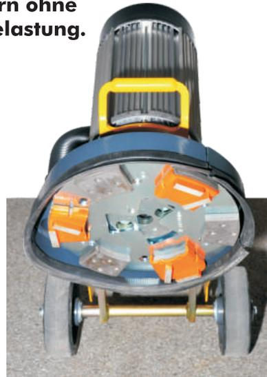
Der schwenkbare Schleifkopf ermöglicht das Arbeiten in drei
